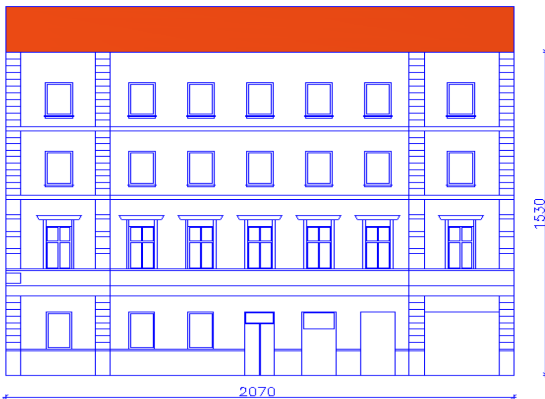
Slika 11: Skica in dimenzije fasade na sprednji strani stavbe
