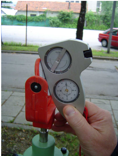
Slika 10: Določanje naklona tarče (levo) in določanje usmerjenosti tarče (desno) [foto: A. Kaluža]
