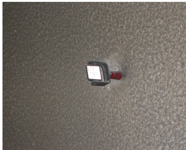
Slika 6: Uporaba prizme (levo) in bireflex tarče v predoru (desno) [foto: J. Klopčič]
