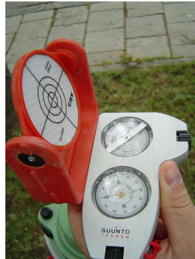
Slika 10: Določanje naklona tarče (levo) in določanje usmerjenosti tarče (desno) [foto: A. Kaluža]
