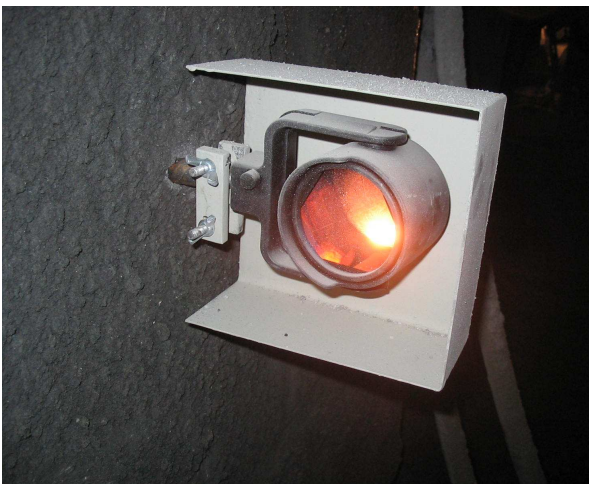
Slika 6: Uporaba prizme (levo) in bireflex tarče v predoru (desno) [foto: J. Klopčič]
