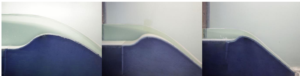
Slika 4-19: Primerjava fotografij prelivnega curka na modelih 1:26 (leva fotografija), 1:50 (srednja fotografija) in 1:100 (desna fotografija) za nominalni pretok 214 \text{ m}^3/\text{s} .
