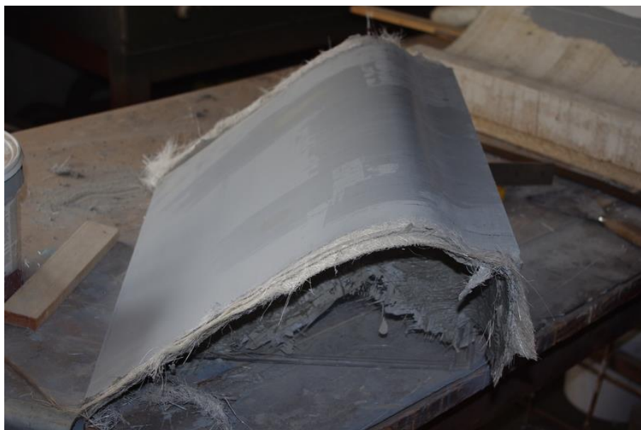
Slika 4-4: Preliv v merilu 1:100 v fazi izdelave.
