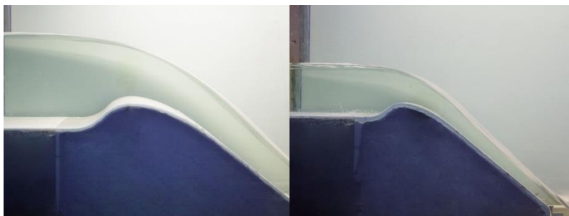
Slika 4-17: Primerjava fotografij prelivnega curka na modelih 1:50 (leva fotografija) in 1:100 (desna fotografija) pri nominalnem pretoku 821 \text{ m}^3/\text{s} .
