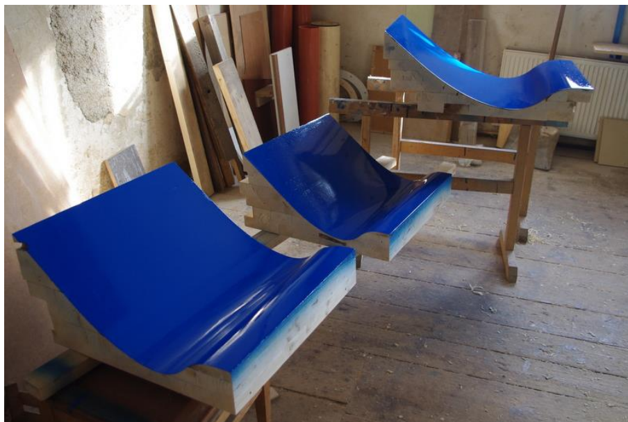
Slika 4-3: Negativi za izdelavo modelov prelivov.
