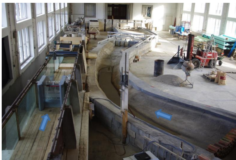
Slika 3-1: Prostorski hidravlični model HE Suhadol v merilu 1:38 (desno) in parcialni hidravlični model prelivnega polja v merilu 1:26 v steklenem žlebu (levo) v laboratoriju Inštituta za hidravlične raziskave v Ljubljani.
