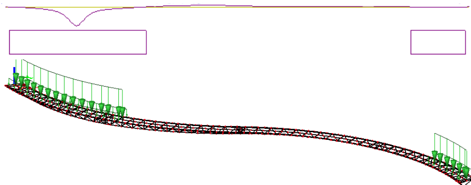
Slika 83: Primer vplivnice in razporeditev obtežbe glede na vplivnico Figure 83: An example of an influence line and derived load distribution
