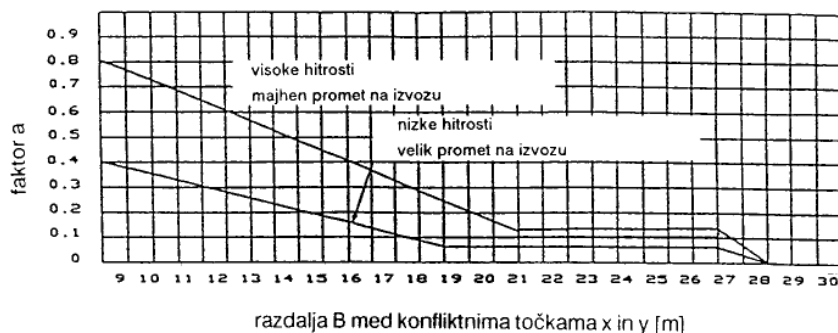
Grafikon 2: Diagram določitve koeficienta a glede na razdaljo B (TSC 03. 341 : 2011, str. 21)
