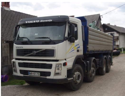
Slika 25 Tovorno vozilo prekucnik, štiriosno, z največjo dovoljeno skupno maso 32.000 kg (Vir: lastni arhiv) Figure 25 Heavy duty vehicle, four axles, rigid, maximum load 32.000 kg (Source: personal archive)
