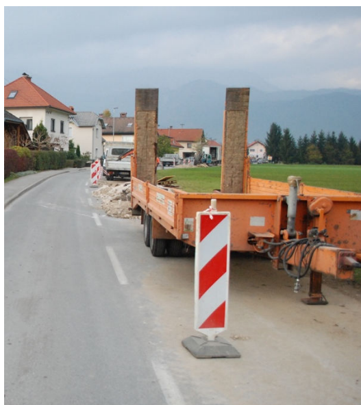
Slika 36 Tovorna prikolica za premik mini bagra, štiriosna (Vir: lastni arhiv)
