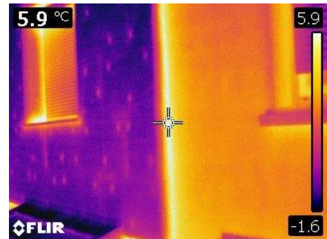
Slika 4: Stena, ki je le delno toplotno izolirana.
