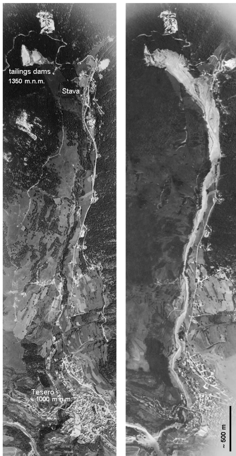
Slika 1.2: Pogled na dolino Stava pred in po blatnem toku zaradi porušitve jalovinskih pregrad Prestavel (Petkovšek in Pulko (2015) po WISE Uranium Project (2009)).
