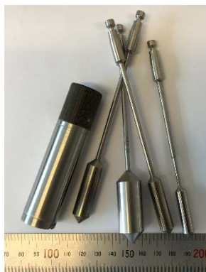
Slika 4.8: DV3T HB reometer (levo), koaksialni cilindri z vreteni (sredina) in krilne sonde (desno) (foto: arhiv KMTAL).
