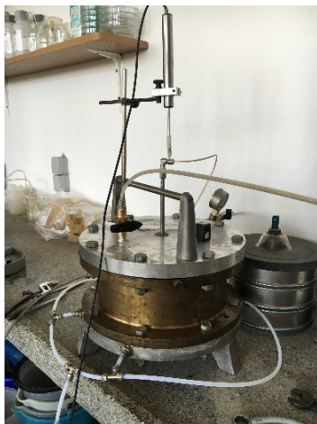
Slika 4.5: Veliki edometer – Rowe celica, v kateri smo s konsolidacijo iztiskali vodo iz sedimentov (foto: arhiv KMTAL).
