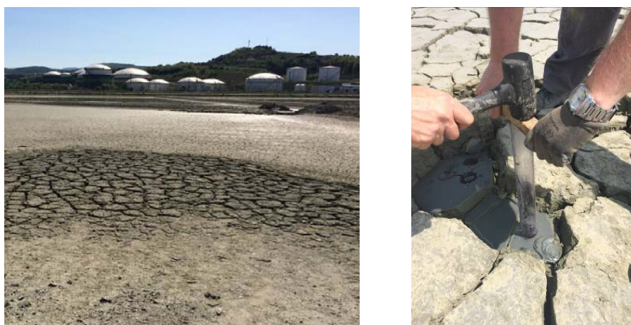
Slika 4.2: Stanje površine v kasetah, kjer reful že več let miruje (fotografirano poleti 2015) (levo) in odvzem intaktnih vzorcev (desno) (foto: arhiv KMTAL).
