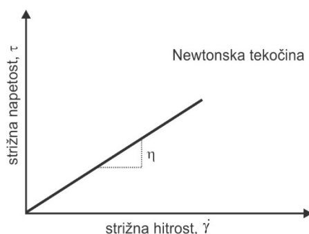
Slika 6.3: Reološko obnašanje Newtonskih tekočin.
