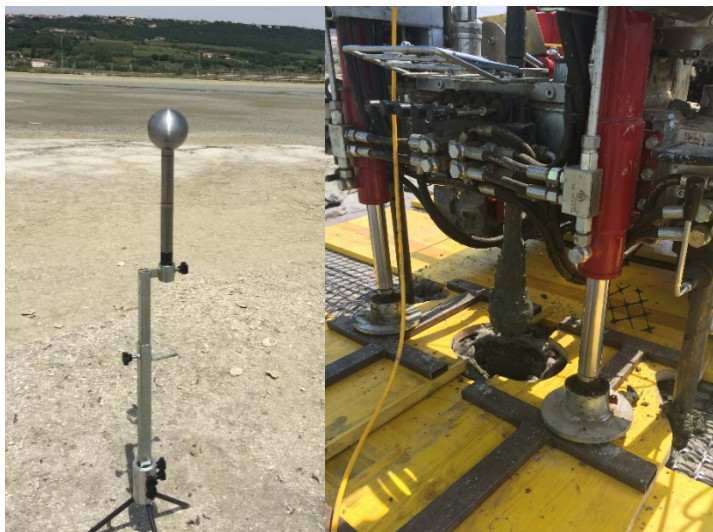
Slika 4.4: Piezokrogla, last podjetja SLP d.o.o., prvič uporabljena za preiskave mehkih sedimentov v Sloveniji (foto: arhiv KMTAL).
