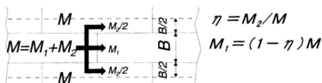
Slika 5-21: Porazdelitev momentov na dva vzajemno delujoča obroča (Blom, 2002).
