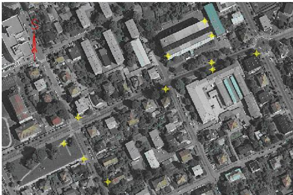
Slika 3.6: Približne lokacije točk, katerim smo z RTK metodo izmere določali koordinate, podlaga rastrska slika [www.geopedia.si].
