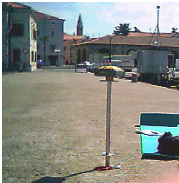
Slika 3.3: Stabilizacija točke SMKP na starem pomolu v Kopru.
