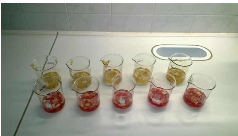
Slika 45: Pripravljene vzorce z grobo žagovino pred mešanjem; v zgornjih petih čašah je voda in žagovina, v spodnjih čašah pa je barvalna raztopina z žagovino
