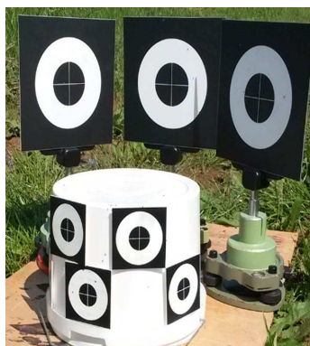
Slika 2.7: Stabilizacija tarč pri enem od poskusov
