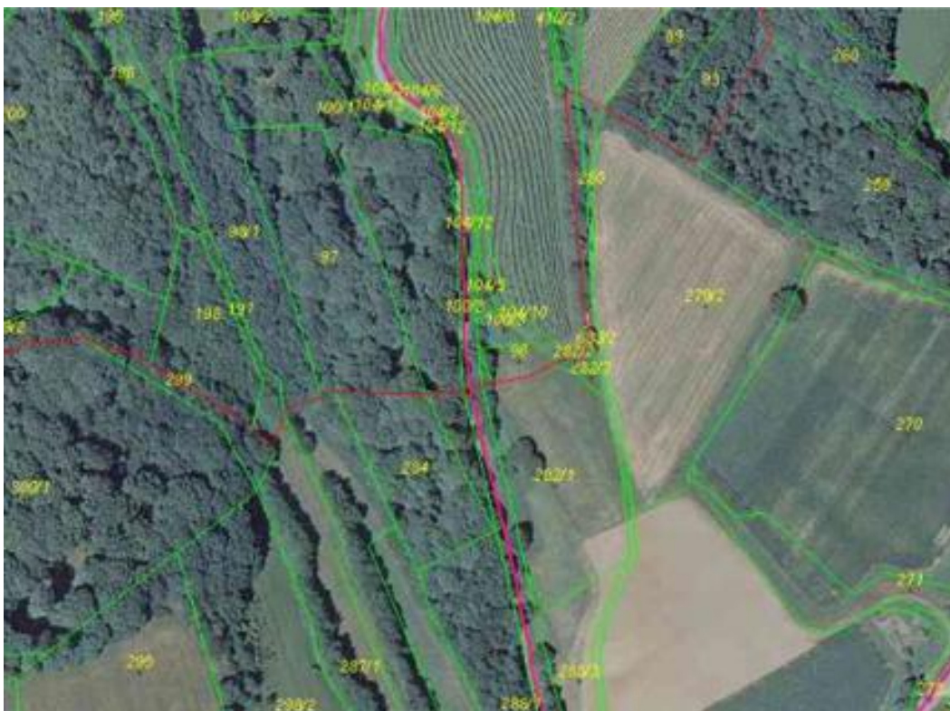
Slika 4 : Prikaz dela ceste, kjer je ena polovica ceste v eni katastrski občini, druga polovica pa v drugi katastrski občini ( digitalnemu katastrskemu načrtu je dodan ortofoto načrt )
