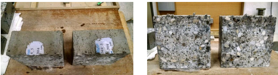
Slika 47: Površina in prečni prezek kocke z uporabo aeranta (levo) in brez aeranta (desno).
