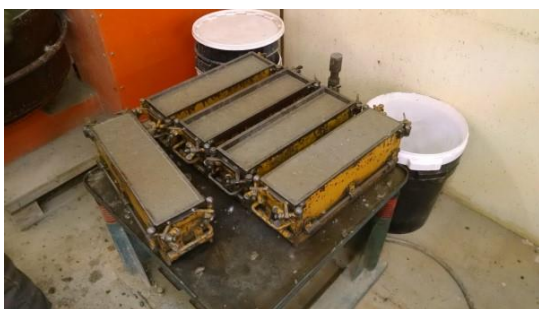
Slika 20: Standardni kalupi – prizme (levo) in kocke (desno).
