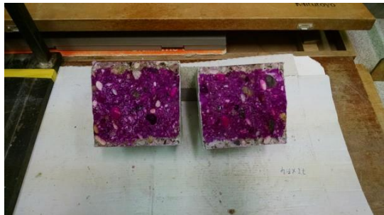
Slika 51: Globina karbonatizacije pri etalonu (levo) in betonu s plastiko (desno) po 56 dneh.
