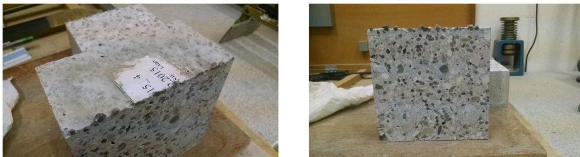
Slika 48: Površina kocke (levo) in prerez kocke z uporabo gostilca (desno).
