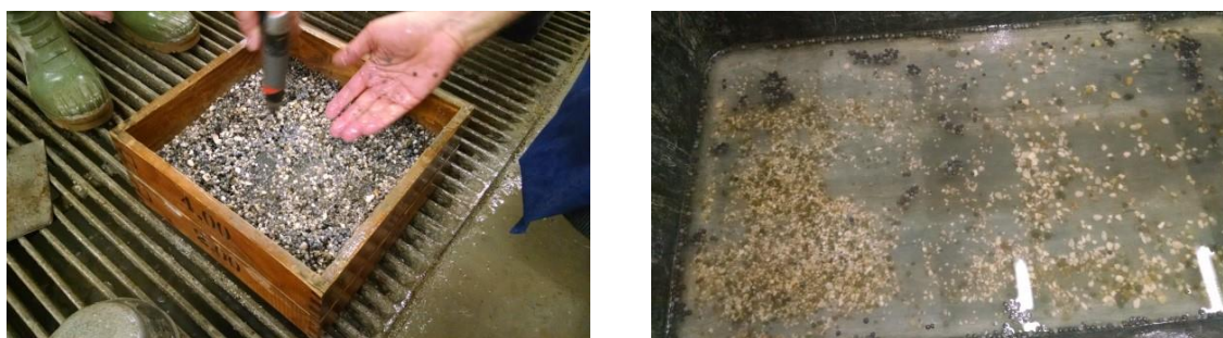
Slika 29: Sejanje plastičnega agregata na sitih (levo) in namakanje v vodi (desno).
