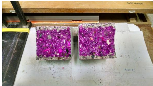
Slika 51: Globina karbonatizacije pri etalonu (levo) in betonu s plastiko (desno) po 56 dneh.
