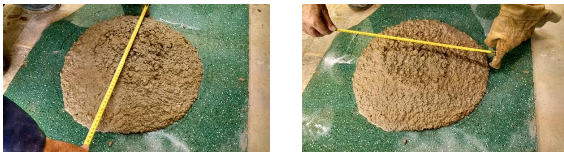
Slika 55: Meritev razleza betona v obeh smereh.
