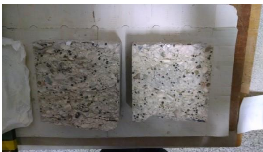
Slika 57: Odsotnost segregacije plastičnega agregata.
