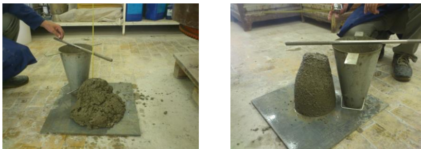
Slika 43: Posed betona etalon (levo) in betona PP10 (desno).
