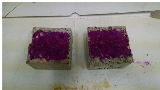
Slika 52: Globina karbonatizacije pri etalonu (levo) in betonu s plastiko (desno) po 100 dneh.
