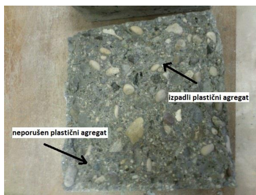
Slika 44: Slab stik med plastičnim agregatom in cementnim kamnom.
