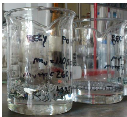
Slika 37: Plavanje plastik Recythen na vodi.
