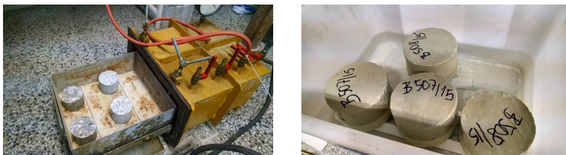
Slika 33: Vakuumska komora (levo) ter hranjenje vzorcev v raztopini NaCl (desno).
