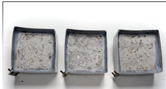
Slika 53: Etalon pred preskusom (levo) in po 25 ciklih (desno).
