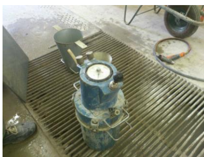
Slika 27: Merjenje vsebnosti zraka s porozimetrom.
