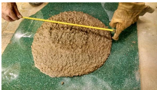
Slika 26: Merjenje razleza betona.
