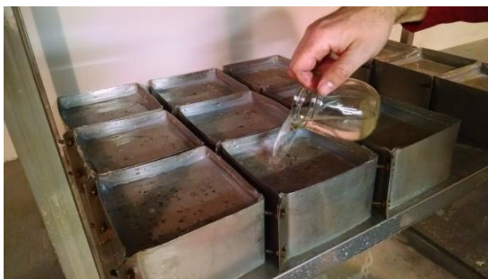
Slika 36: Vzorci izpostavljeni raztopini NaCl (levo) in izpiranje odluščenega materiala (desno).
