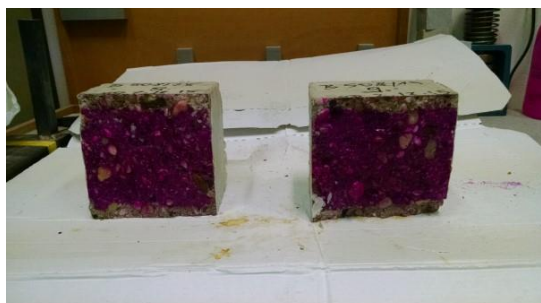
Slika 52: Globina karbonatizacije pri etalonu (levo) in betonu s plastiko (desno) po 100 dneh.
