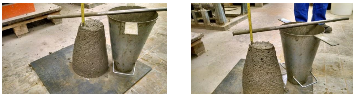
Slika 49: Posed betona etalon_novi (levo) in betona PP10_optim. EFP_GOST (desno).
