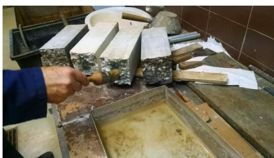
Slika 32: Tesnjenje vzorcev s parafinom.
