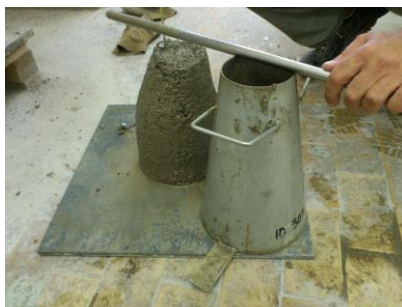
Slika 25: Merjenje poseda betonskega stožca.
