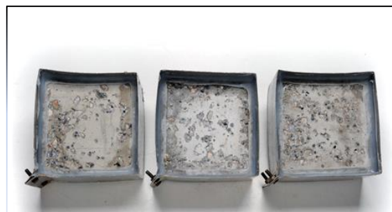
Slika 54: Beton s plastiko pred preskusom (levo) in po 25 ciklih (desno).
