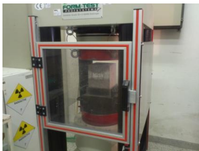
Slika 30: Preiskava tlačne trdnosti.
