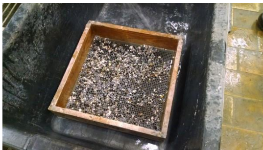
Slika 16: Sejanje plastičnega agregata na situ.
