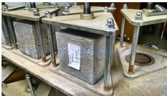
Slika 31: Izpostavljenost vzorcev vodnemu tlaku.
