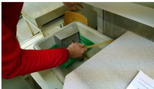
Slika 36: Vzorci izpostavljeni raztopini NaCl (levo) in izpiranje odluščenega materiala (desno).
