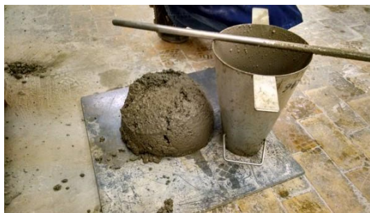
Slika 46: Posed betona PP10_AER (levo) in betona PP10_optim. EFP (desno).
