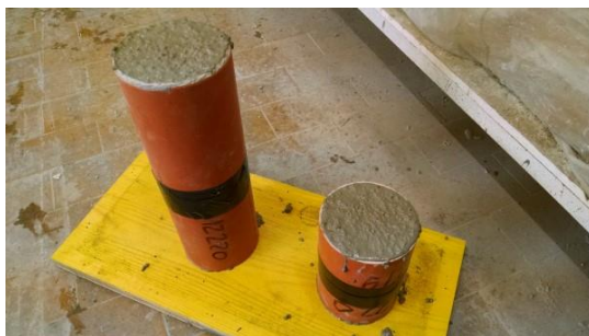
Slika 56: Minimalna segregacija plastičnega agregata.
