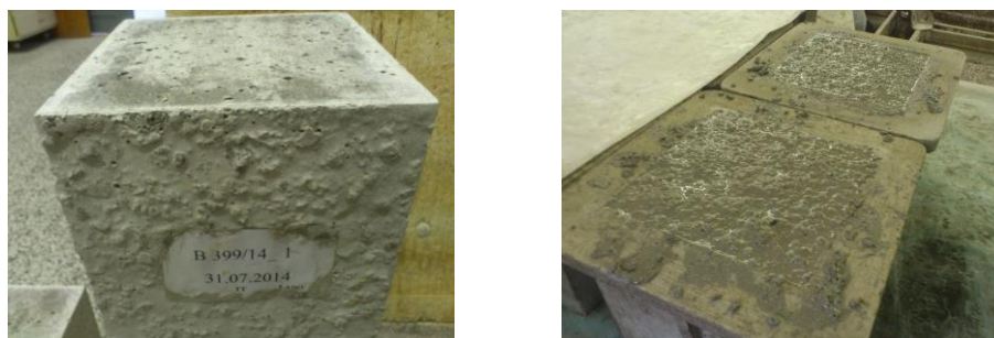
Slika 45: Segregacija plastike Recythen PO AGG (levo) in Recythen PP10 (desno).
