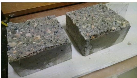
Slika 50: Globina prodora vode pri betonu s plastiko (levo) in etalonu (desno).
