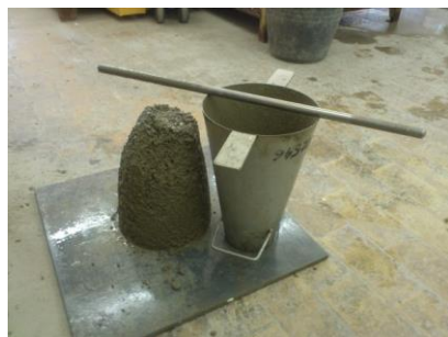
Slika 46: Posed betona PP10_AER (levo) in betona PP10_optim. EFP (desno).
