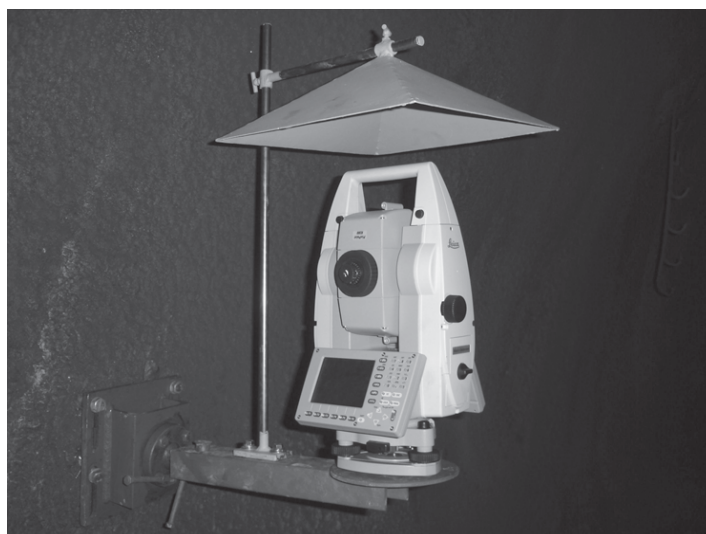
Elektronski tahimeter Leica TCRP1201 R300 na konzoli v predoru (poročilo o predoru) (Marjetič et al., 2006, str. 14)
