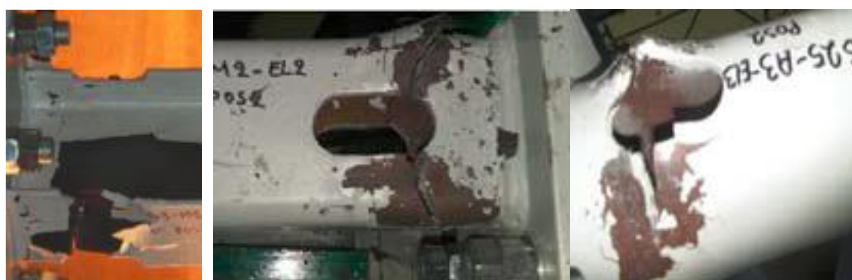
Slika 17: Detajl pojava plastifikacije na testiranih oslabiljenih FUSEIS1 elementih: I prerez (levo), pravotkoni votli prerez (v sredini), okrogli votli prerez (desno) (Vayas idr., 2013)
