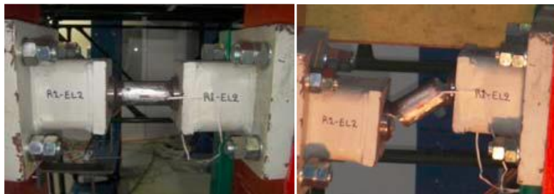
Slika 18: FUSEIS zatič pred testiranjem (levo) in po testiranju (desno) (Vayas idr., 2013)
