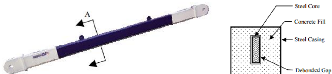
Slika 7: Primer diagonale s preprečenim uklonom (levo) in prečni prerez elementa (desno) (Hussain idr., 2006)
