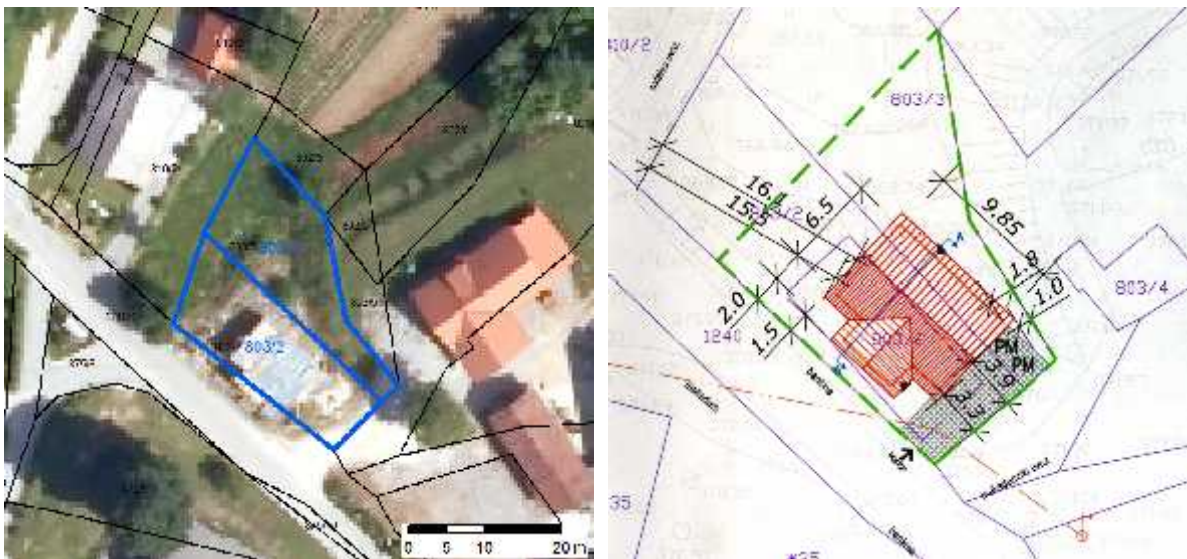
Slika 32: Prikaz zemljiških parcel, deli katerih sestavljajo gradbeno parcelo ter izsek iz gradbenega dovoljenja, kjer je grafi ni prikaz obsega gradbene parcele (Geodetska uprava RS in MO Novo mesto)
