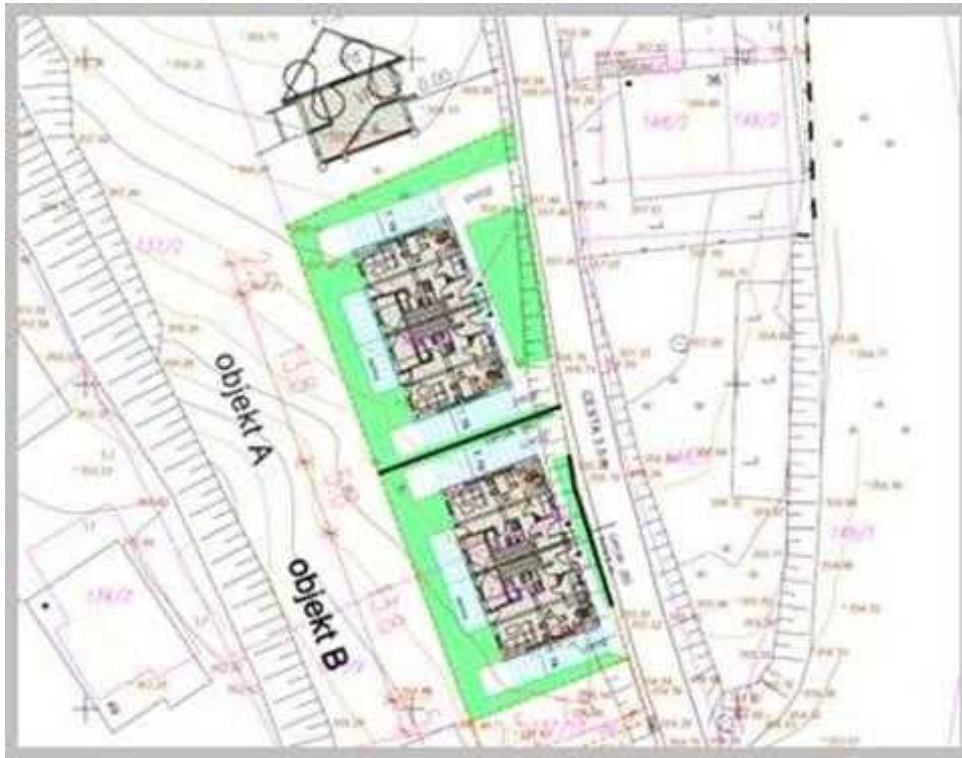
Slika 20: Primer dolo itve gradbene parcele v lokacijskem delu PGD (zelena barva) (erne, 2015)
