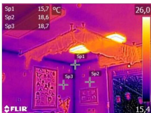
Slika 26 termografski posnetek kombiniranega toplotnega mostu 2
