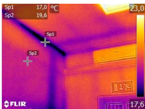
Slika 25 termografski posnetek kombiniranega toplotnega mostu 1
