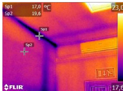
Slika 23: Kombiniran toploni most (leva slika), termografska slika kombiniranega toplotnega mostu (desna slika).
