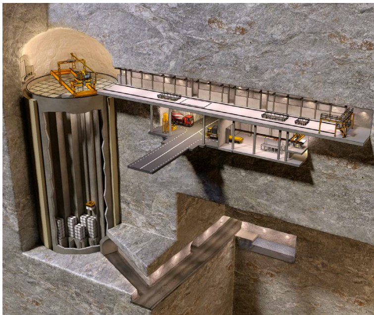
Slika 1: Shematski prikaz silosa v odlagališču Forsmark na Švedskem (Svensk Kärnbränslehantering AB, 2015)
