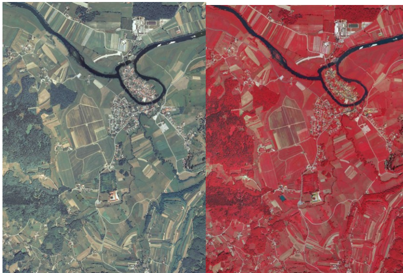
Slika 4: Primer barvnega in infrardečega ortofota (VIR: GURS)
