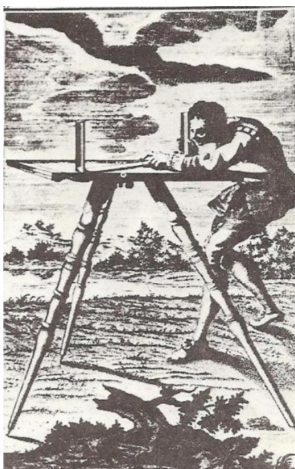
Slika 12: Prikaz merjenja z mersko mizo (Korošec, 1978)
