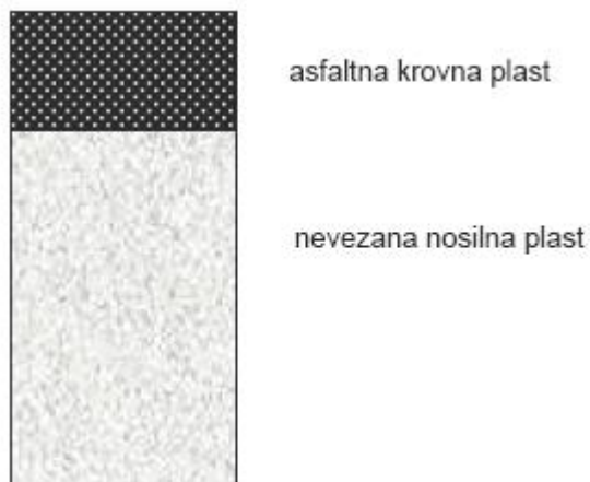
Slika 3: Asfaltna voziščna konstrukcija s spodnjo nosilno plastjo iz nevezane zmesi zrn (vir: TSC 06.520. 2003, str. 8).
