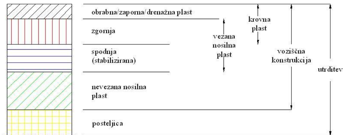
Slika 1: Značilni prečni prerez ceste (vir: Žmavc, J. 2007, str. 13).
