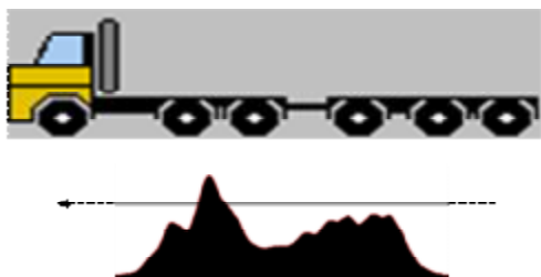
Slika 22: Klasifikacija na osnovi induktivnega vozila (vir: UM FG 2008).
