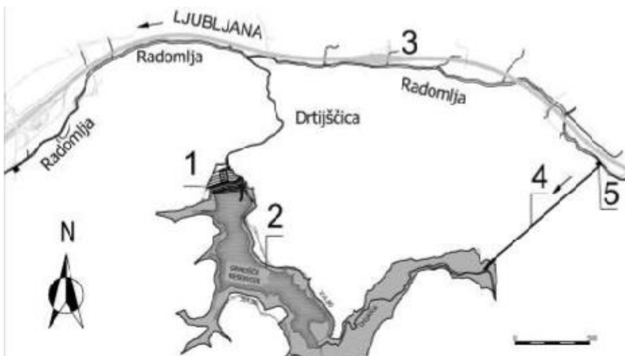
Slika 1: Prikaz sistema Drtjščica (1-pregrada Drtjščica, 2-zadrževalnik Gradiško jezero, 3-avtocesta, 4-tunelski prepust, 5-vtočni kanal reke Radomlje). (Humar, Kryžanowski, 2012)
