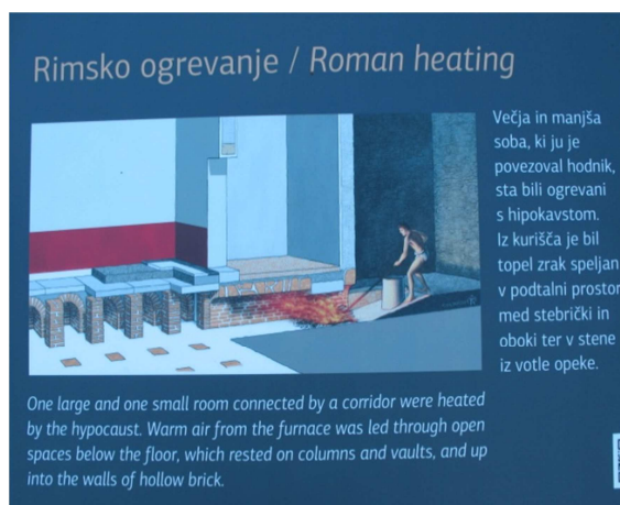
Slika 6: Iz kurišča je bil topel zrak speljan v podtalni prostor.
