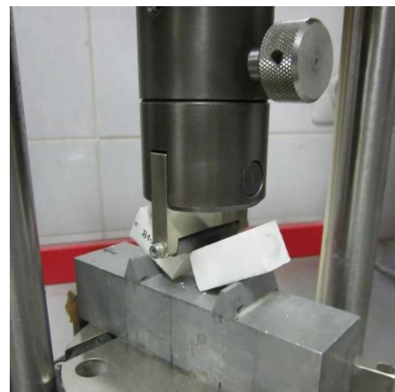
Slika 13: Zasnova (levo) in izvedba preizkusa upogibne trdnosti (desno)
