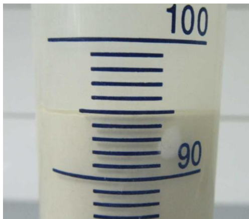
Slika 15: Izločanje vode pri injekcijski masi
