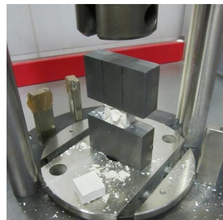
Slika 14: Shema (levo) in izvedba tlačnega preizkusa (desno)
