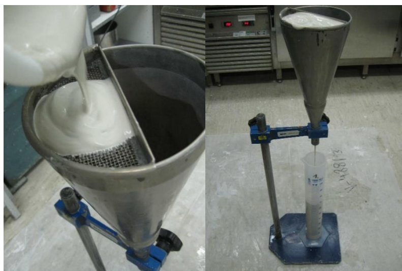
Slika 9: Izvajanje meritve pretočnosti pripravljenih injekcijskih mas
