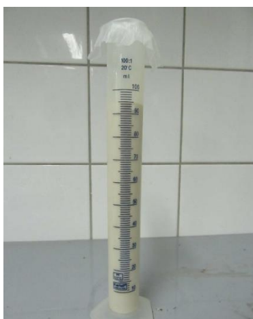
Slika 10: Meritev izločanja vode iz pripravljenih injekcijskih mas
