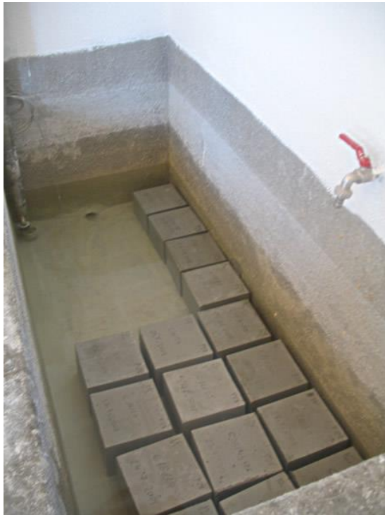
Slika 35: Betonske kocke, postavljene v zaboj z vodo [5]
