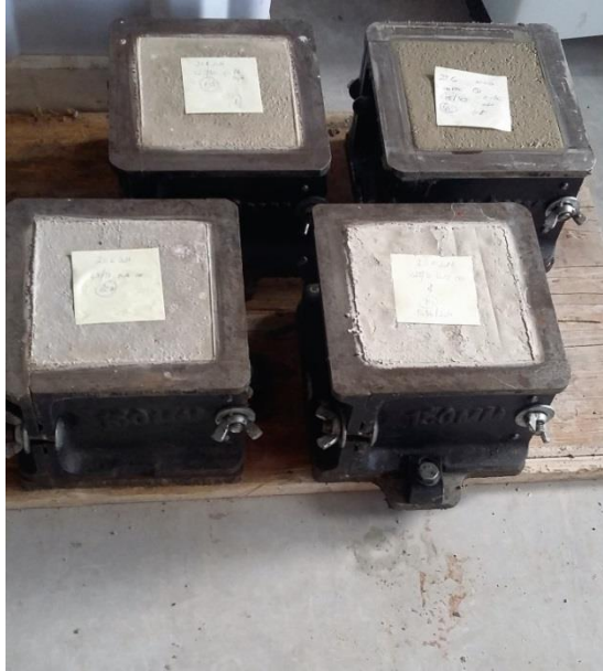
Slika 34: Izdelava kock v jeklenih kalupih s stranico 150 mm [16]
