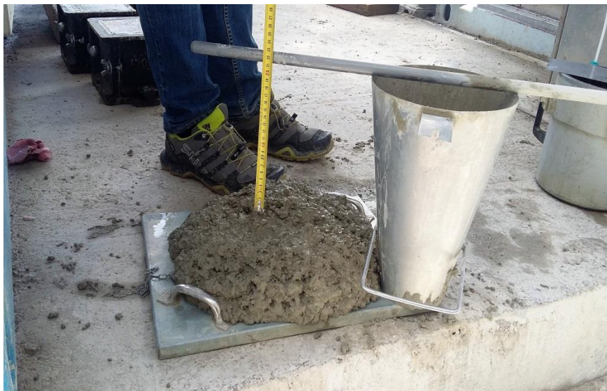
Slika 29: Rezultat preizkusa konsistence sveže betonske mešanice z metodo poseda [16]
