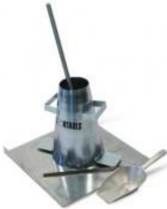
Slika 28: Oprema za preizkus konsistence sveže betonske mešanice za metodo poseda [5]
