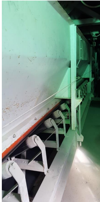
Slika 9: Doziranje agregatov na trak ter avtomatsko tehtanje na elektronski tehnici [16]
