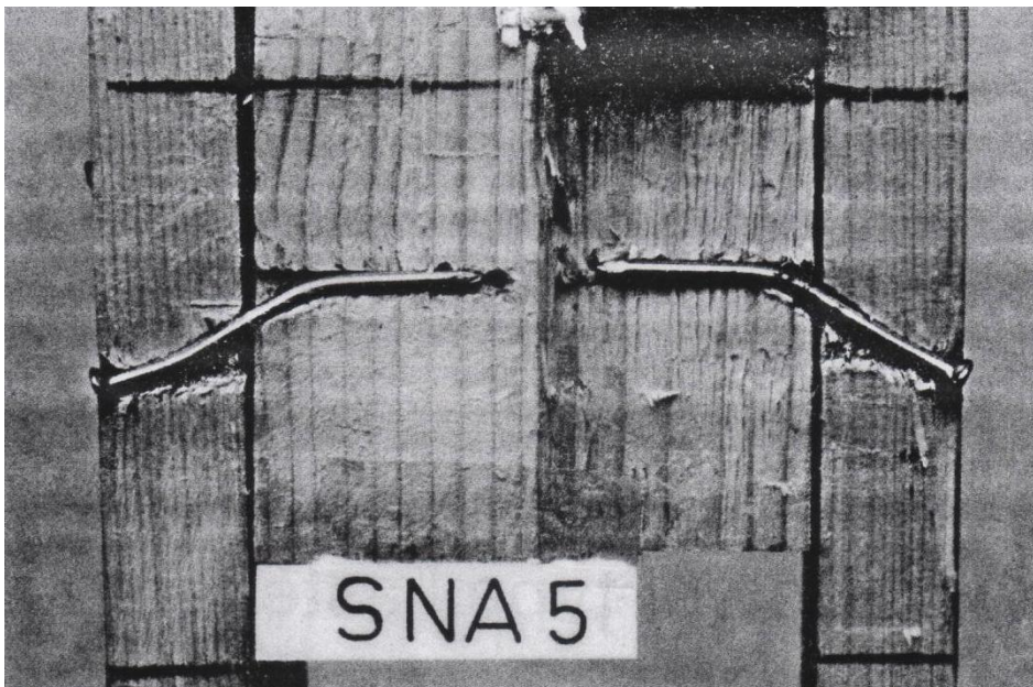
Slika 1: Odprt žebelj priključek po testu, s katerim je bila določena odpornost [1]
