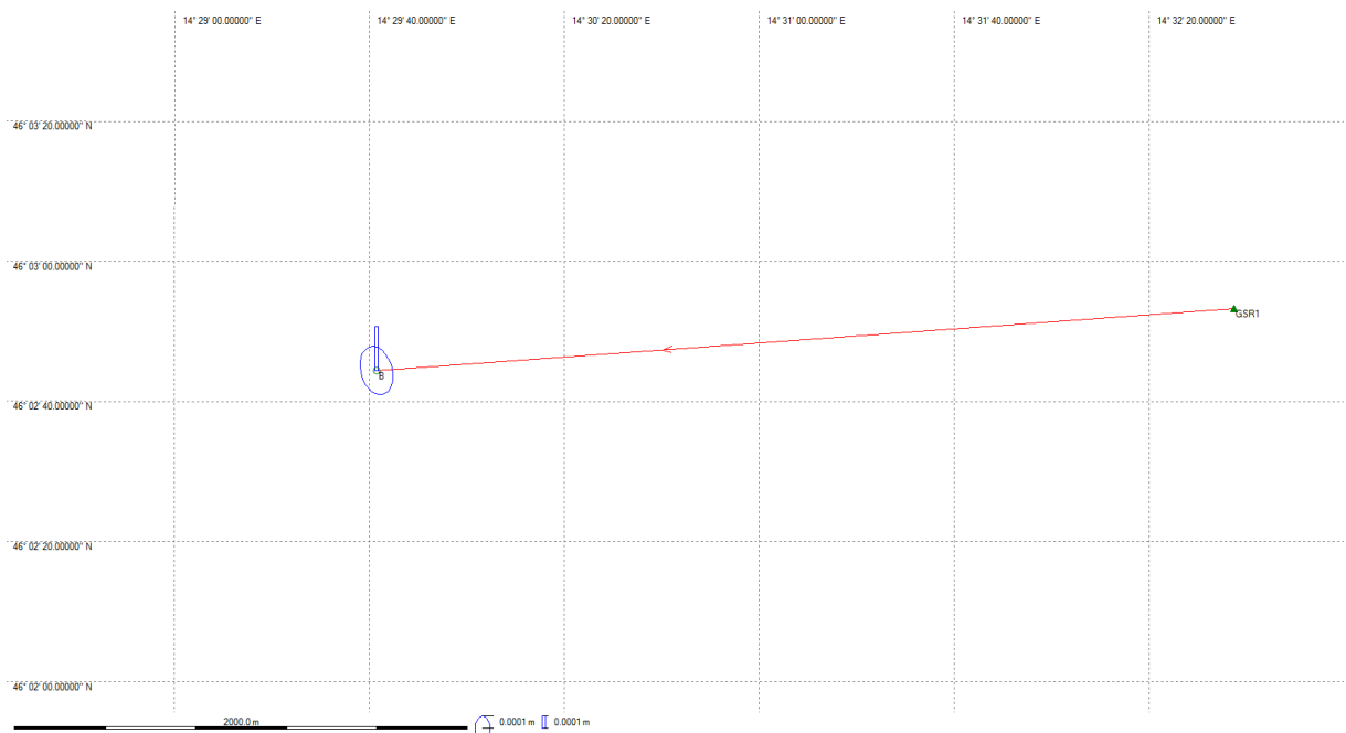
Slika 24: Standardna elipsa pogreškov pri obdelavi točke B s pomočjo stalno delujoče postaje
