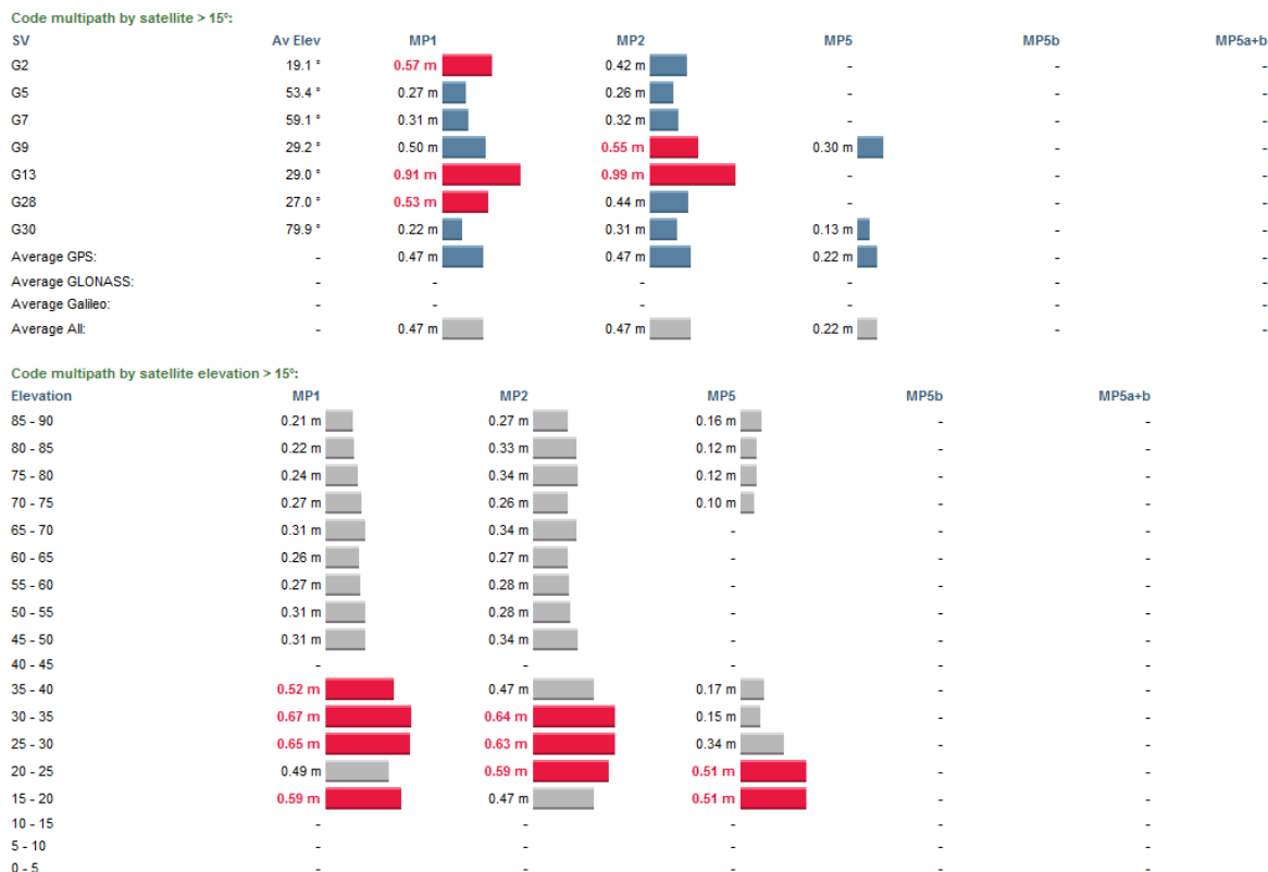
Slika 31: Izris preverjanja kakovosti enournih GNSS opazovanj ob uporabi not. ant. in les. plošče
