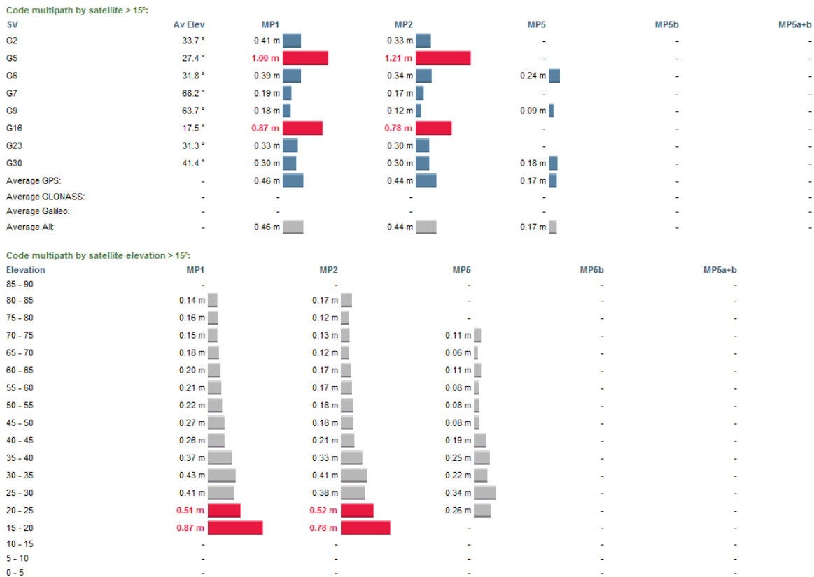
Slika 28: Izris preverjanja kakovosti enournih GNSS opazovanj ob uporabi antene s kovinskim ohišjem
