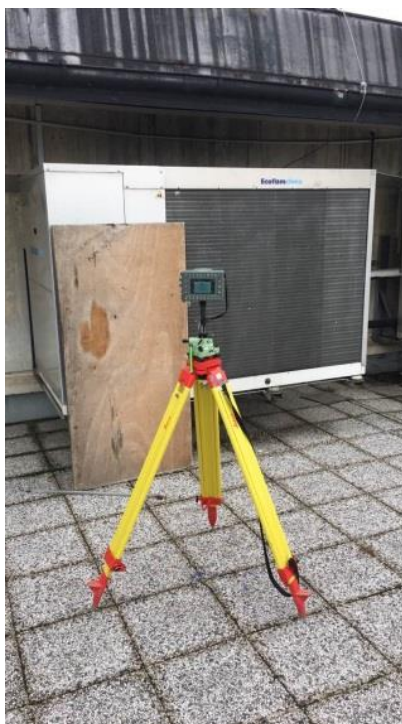
Slika 18: Izvajanje opazovanj GNSS ob pokritju kovinske ovire z leseno ploščo
