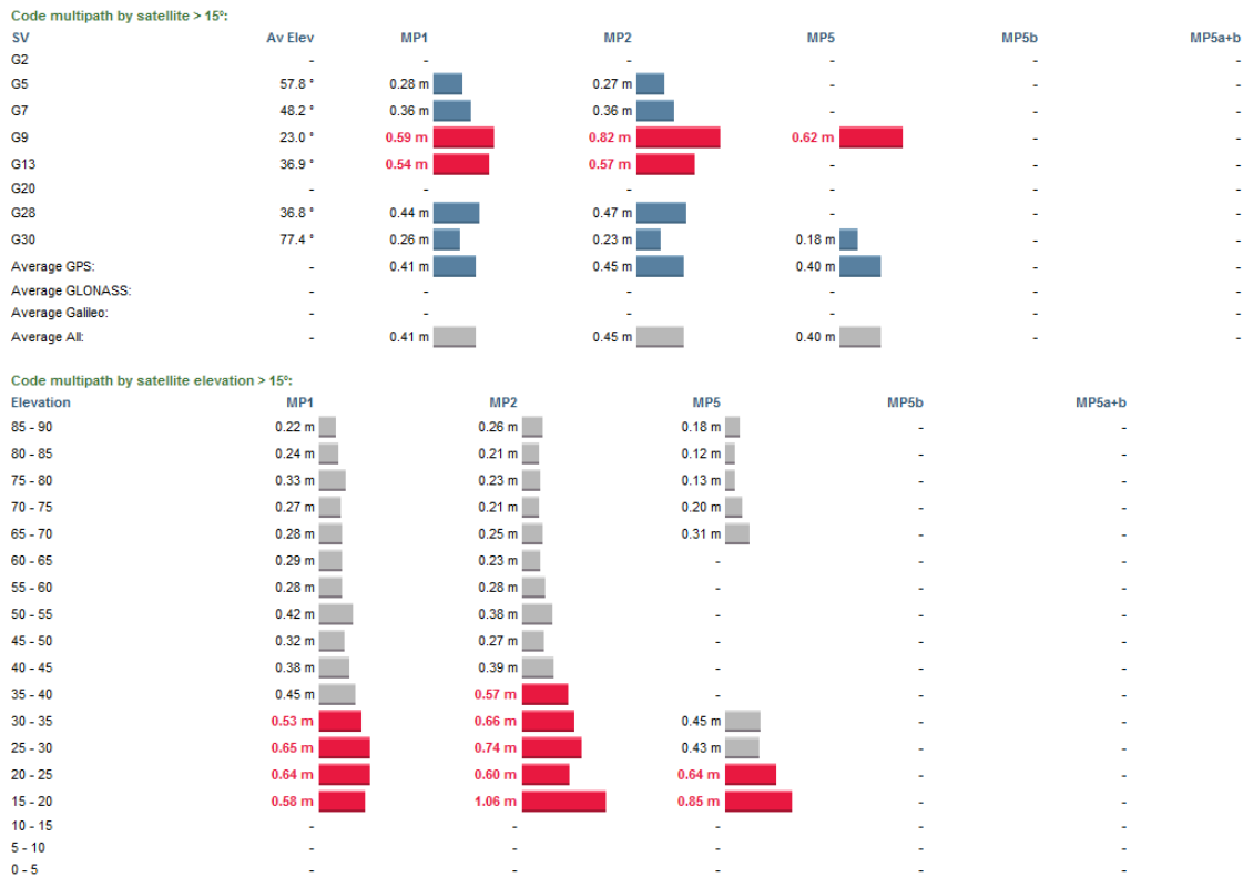
Slika 30: Izris preverjanja kakovosti enournih opazovanj GNSS ob uporabi not. ant. in bele rjuhe
