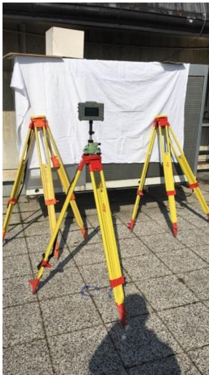
Slika 17: Izvajanje opazovanj GNSS ob pokritju kovinske ovire z belo rjuho
