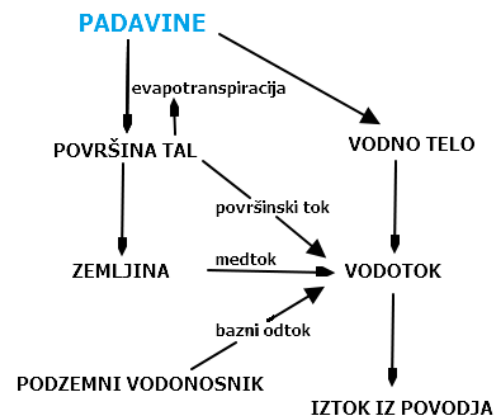
Slika 3: Poenostavljen model hidrološkega kroga v programu HEC HMS (povzeto po Brilly, Šraj, 2005)
