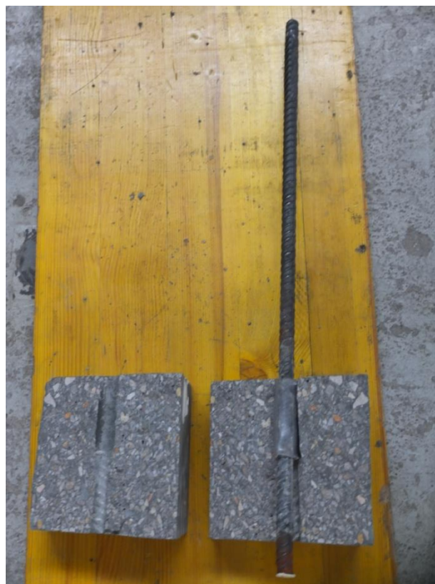
Slika 16: Lepo vidna porušitev vzorca in sidrna dolžina 5d. Izvlek palice iz betona in razcep betona na dva dela
