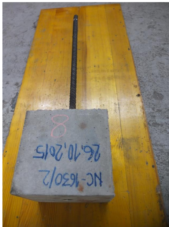
Slika 14: Primerno označen preizkušanec iz betona normalne trdnosti po 28 dneh
