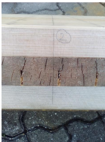
Slika 51: Profil za pregled zamikov po končanem testiranju
