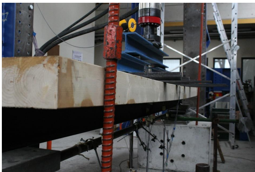
Slika 30: Vmesno stanje, nosilec na meji elastičnosti pri 81 kN
