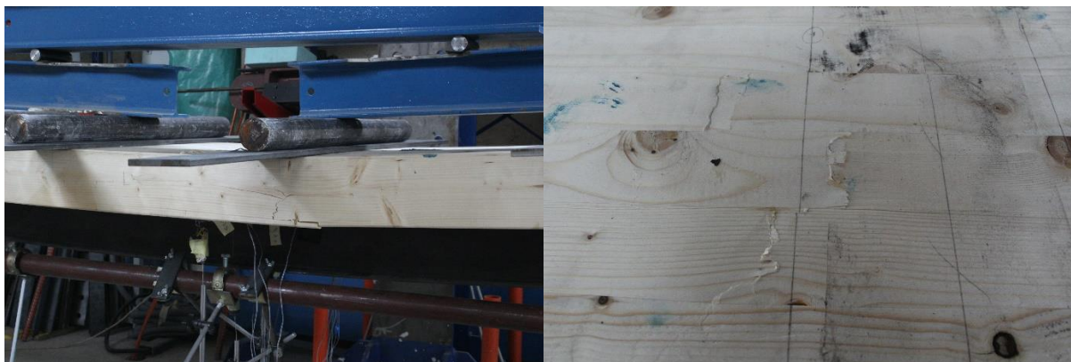
Slika 37: Odziv preizkušanca – porušitev lesene plošče (levo) in deformacije v leseni plošči zaradi tlačnih napetosti (desno)
