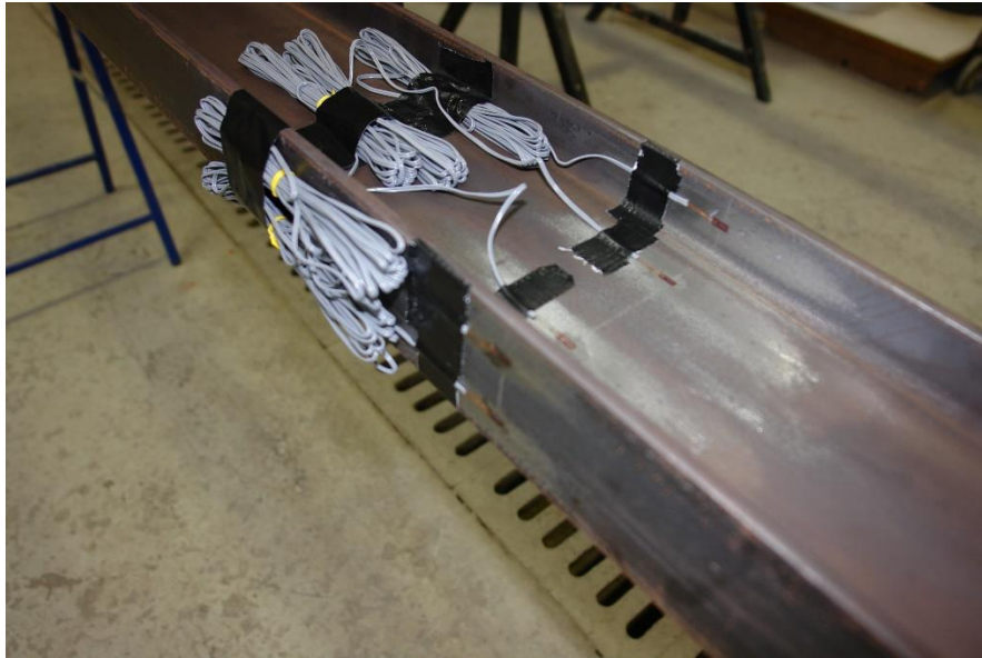
Slika 10: Položaj merilnih lističev na jeklenem nosilcu
