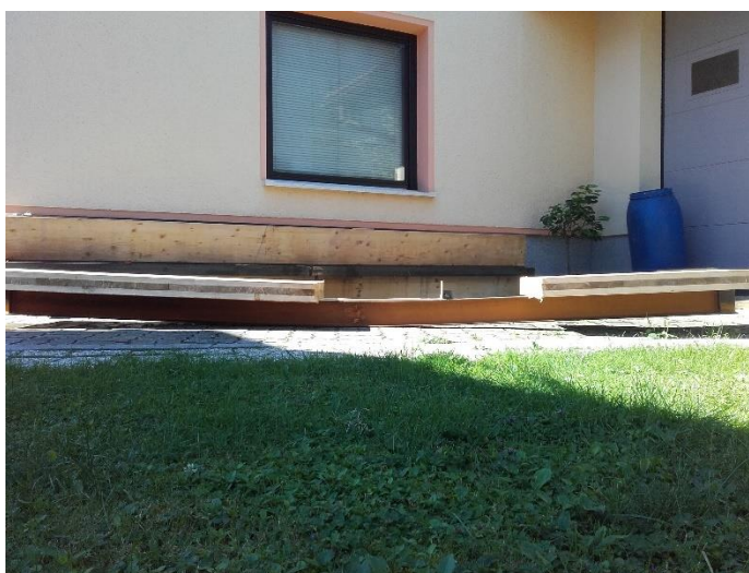
Slika 38: Odziv preizkušanca – zaostale deformacije po zaključenem testu (podoben odziv pri GL in CLT plošči)
