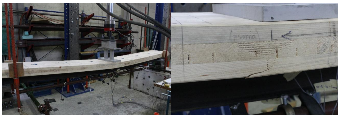
Slika 50: Odziv preizkušanca – točkovno obremenjevanje pri 78 kN (levo) in porušitev (desno)
