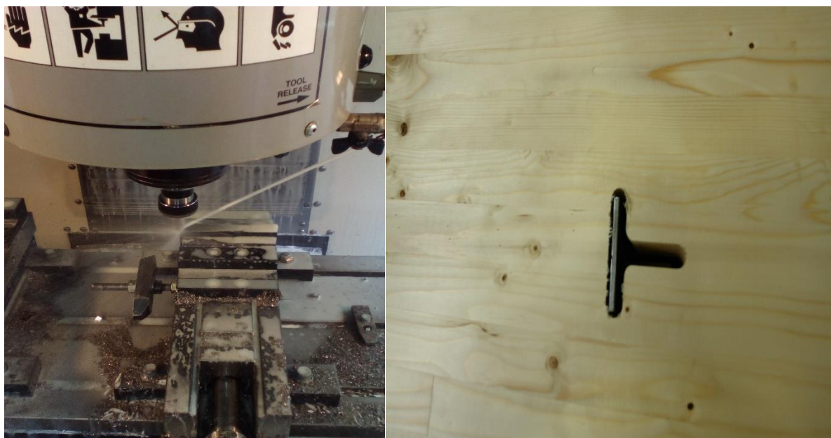
Slika 25: Strojna obdelava ploščic (levo) in detajl sovprežnega spoja (desno)
