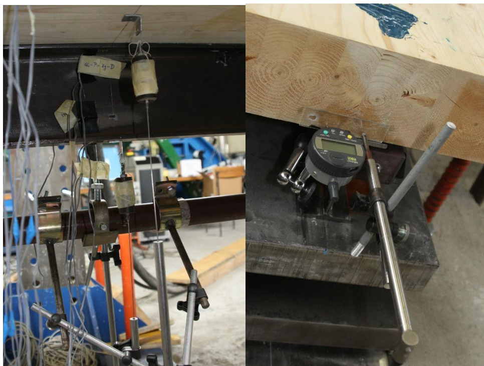
Slika 12: Položaj induktivnih merilcev (levo) in merilec zdrsa (desno)
