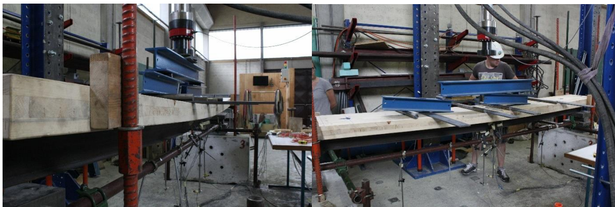
Slika 49: Odziv preizkušanca pri 92 kN (levo) in porušitev statičnega sistema (desno)
