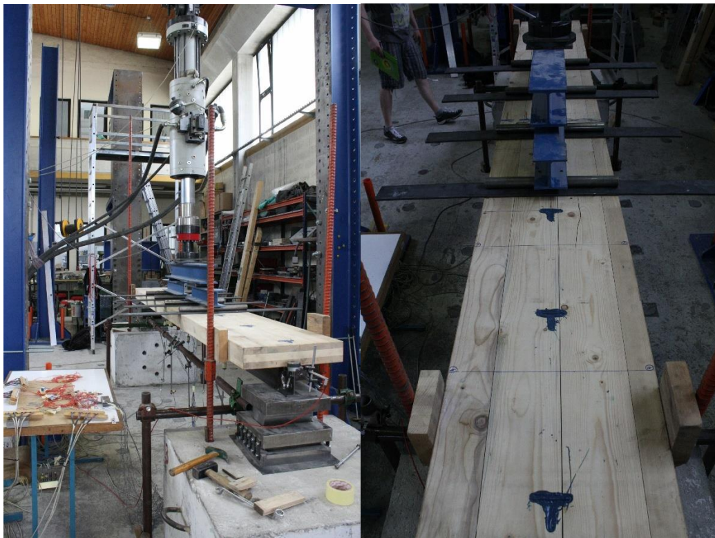
Slika 48: Sistem obremenjevanja (levo) in pogled s strani pred začetkom testa (desno)
