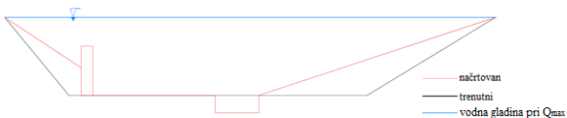
Slika 25: Primerjava trenutnega in načrtovanega prečnega prereza – 2. odsek
