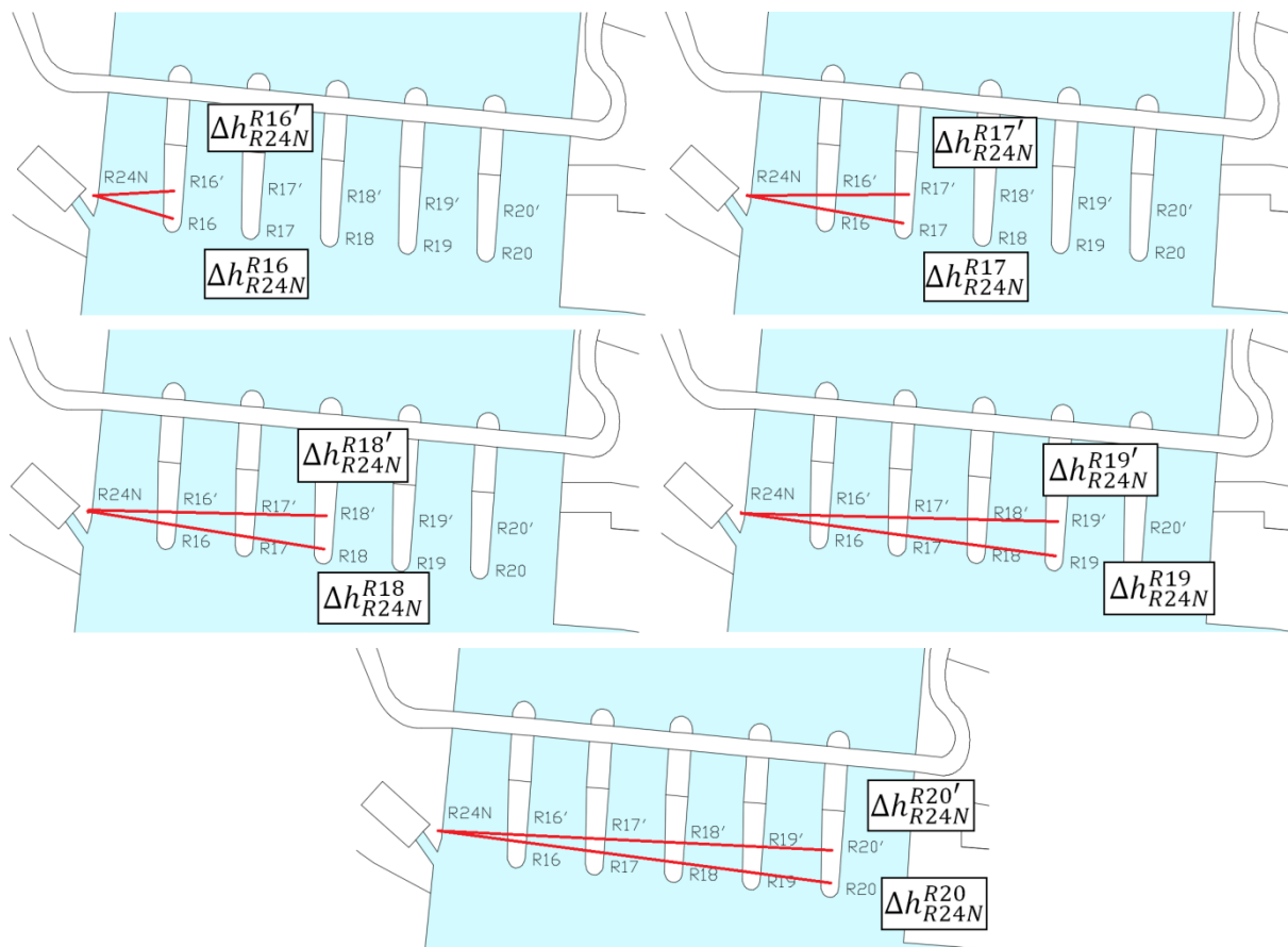
Slika 11: Dejanski prikaz nivelmanskih linij na prelivnih poljih (Vir: Djurić)
