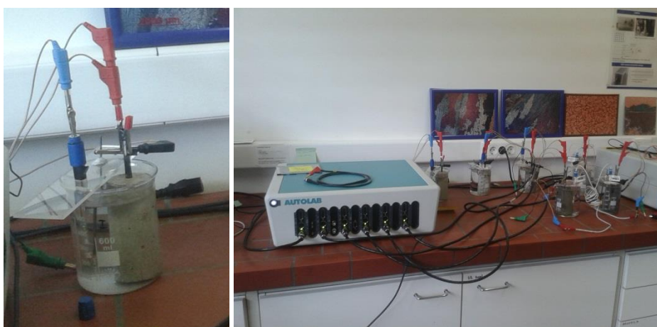
Slika 4.10: Metoda I - korozijska celica in merilni set.
