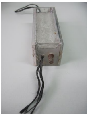
Slika 4.3: Prizmica 30\times 30\times 100\text{ mm}^3 z armaturo in oblepljene s pleksi steklom.
