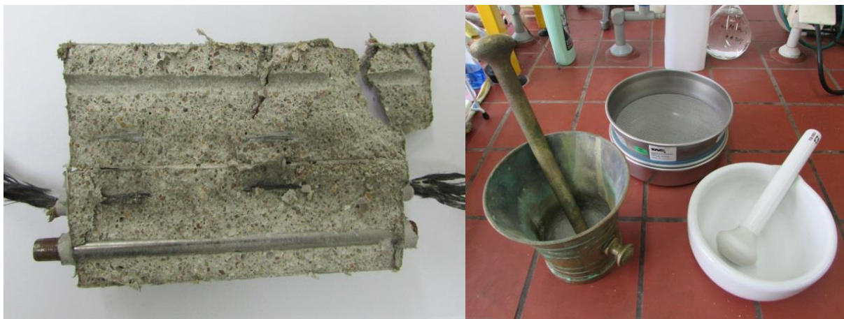
Slika 4.5: Razcepljena prizmica za določanje vsebnosti kloridov (krovna plast zgoraj) in oprema za drobljenje. Figure 4.5: Split specimen for chloride content determination (surface layer above) and crushing equipment.
