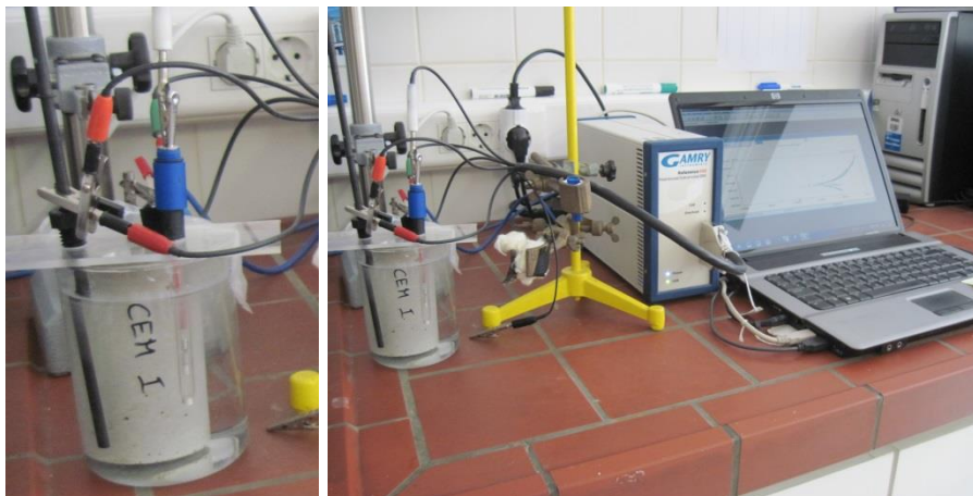
Slika 4.11: Metoda II - korozijska celica in merilni set.
