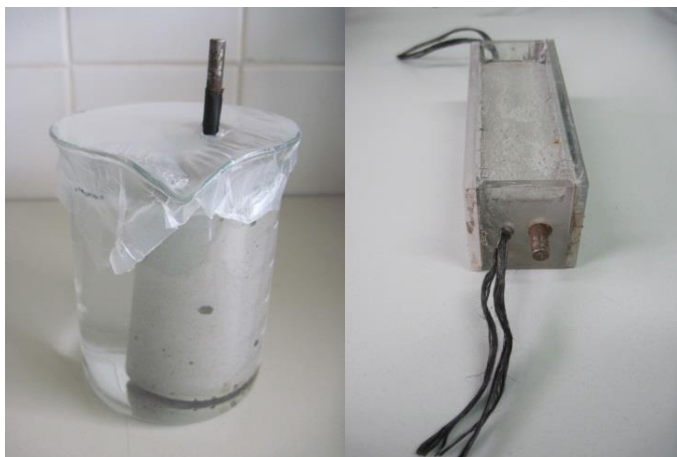
Slika 4.4: Vzorci izpostavljeni pospešeni koroziji z vodno raztopino NaCl (levo - potopljen v 0,1 M raztopini; desno – s prazno posodico iz pleksi stekla).
