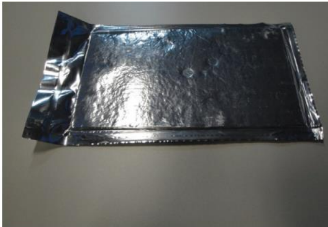
Slika 6: Primer vakuumsko izolacijskega panela proizvedenega v Turna Velenje (Povzeto po [12])
