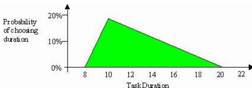
Slika 54: Prikaz primera trikotne porazdelitve verjetnosti izvedbe ali trajanja aktivnosti v določenem intervalu (vir: Primavera Risk Analysis Tutorial)
