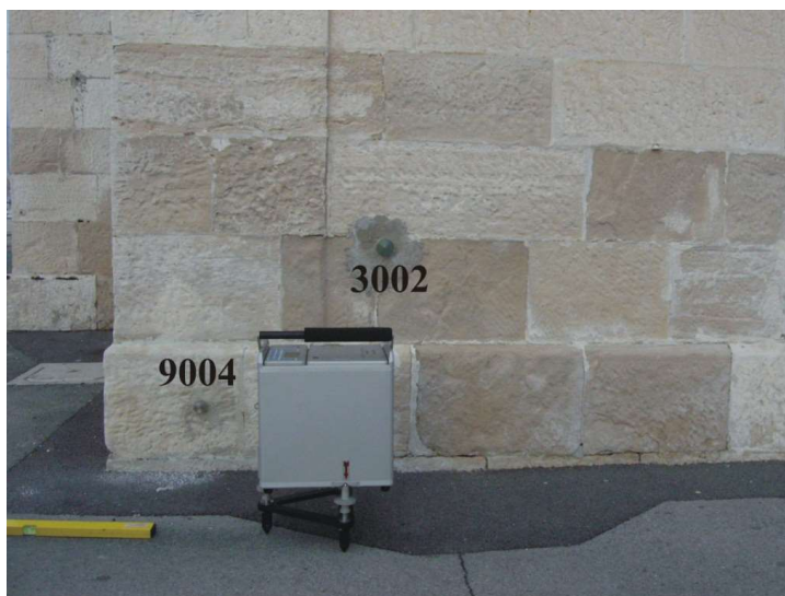
Slika 12: Zamenjava reperja 3002 z reperjem 9004
