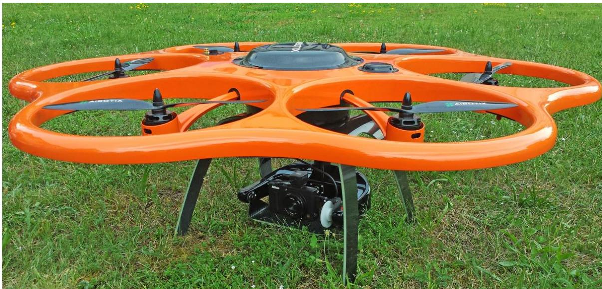
Slika 3.2: Uporabljen brezpilotni letalnik Aibot X6 in fotoaparat Nikon CoolPix A
