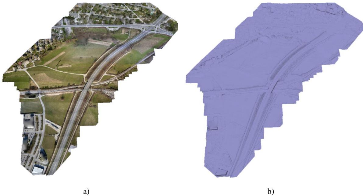
Slika 5.2: Izdelan 3D model reliefa, (a) v pravih barvah, (b) prikaz ploskve
