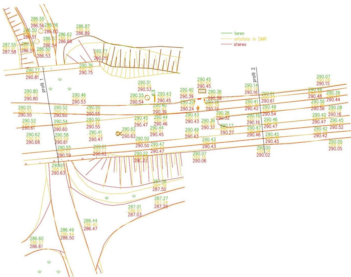
Slika 5.12: Grafični prikaz odstopanj med metodami na primeru železnice
