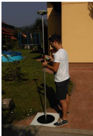
Slika 3.3: Signalizacija in GNSS-izmera oslonilnih točk
