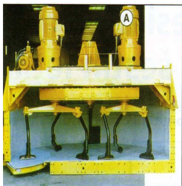
SLIKA 8: Prisilno planetarni mešalnik
