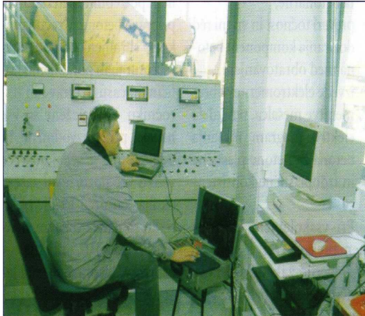
SLIKA 11: Preverjanje proizvodne sposobnosti betonarne
