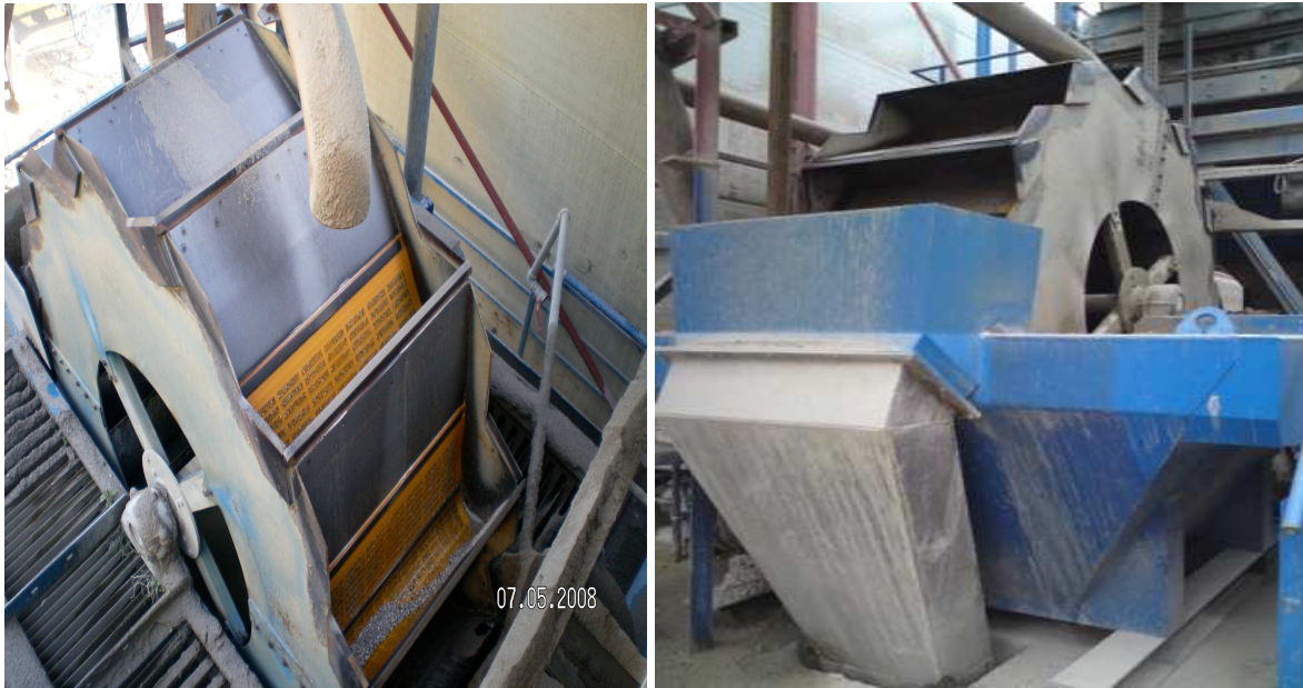
SLIKA 39 in 40: Separacija in čiščenje agregata
