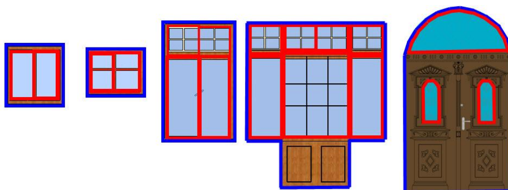
Slika 23: Obseg stikov zasteklitve (rdeče) in obseg gradbenih odprtin (modro)
