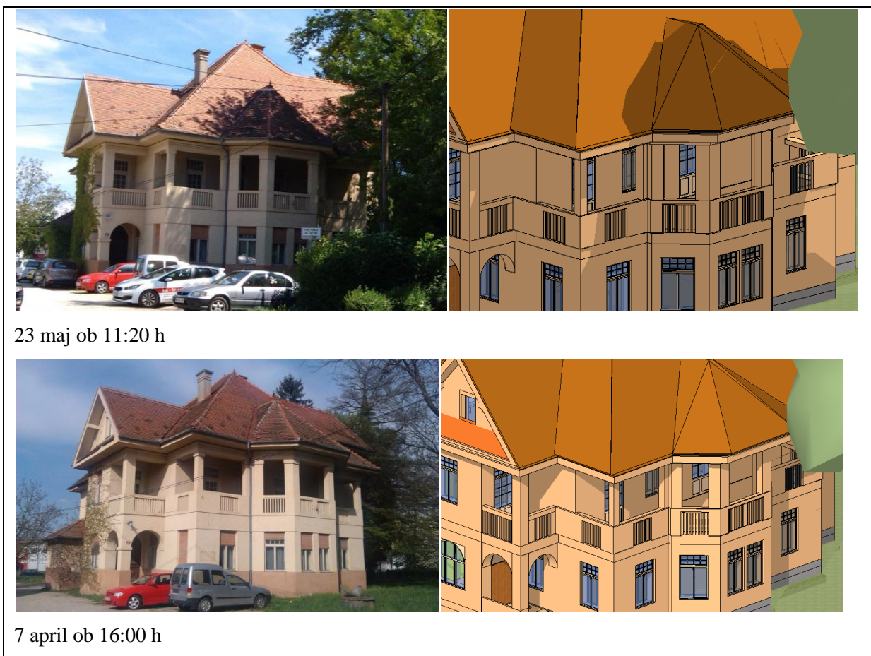
Slika 10: Kontrola ujemanja senčenega objekta s senčenjem modela stavbe (vir: lasten, 2016)
