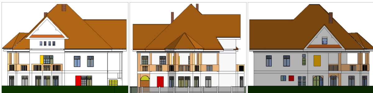
Slika 9: Prikaz izbranih zbiralnih površin po straneh (od leve proti desni si sledijo V, J in Z fasada)
