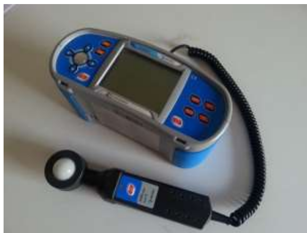
Slika 12: Merilni inštrument Metrel MI 3105 Eurotest XA.
