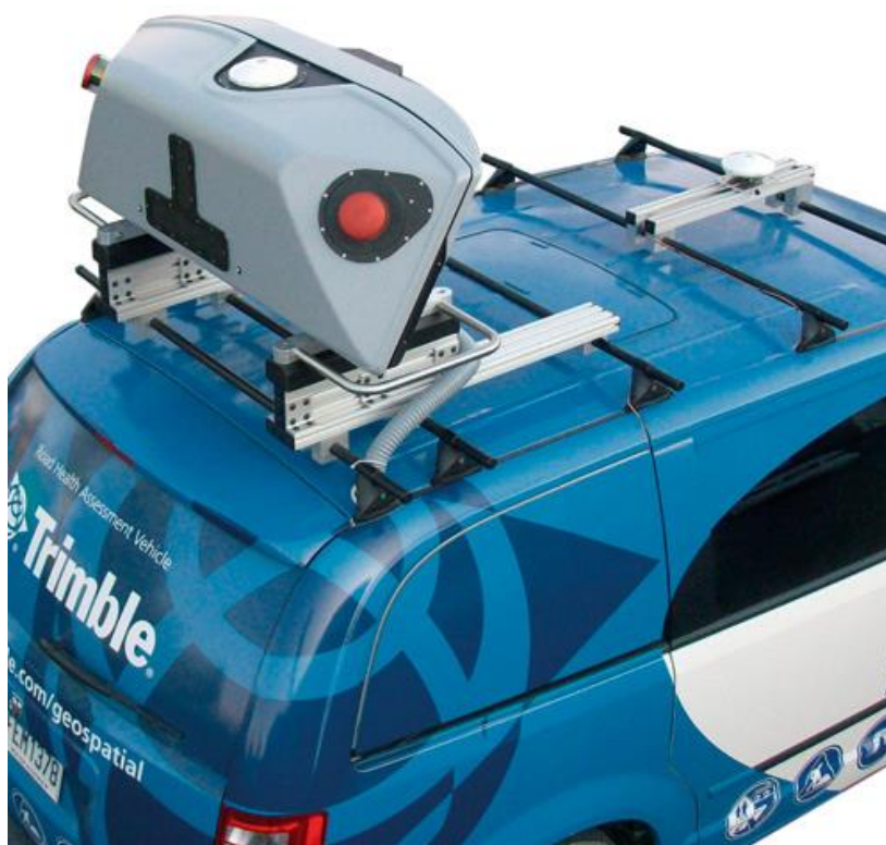
Slika 40: Sodobni sistem za mobilno lasersko skeniranje Trimble MX8 (Trimble, 2016)
