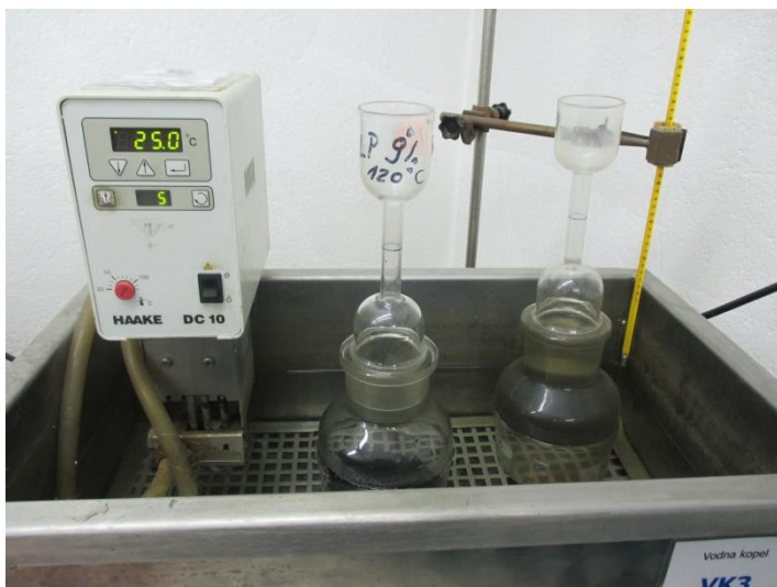
Slika 4-10: Temperiranje vzorca asfaltnih zmesi v vodni kopeli pri 25 °C
