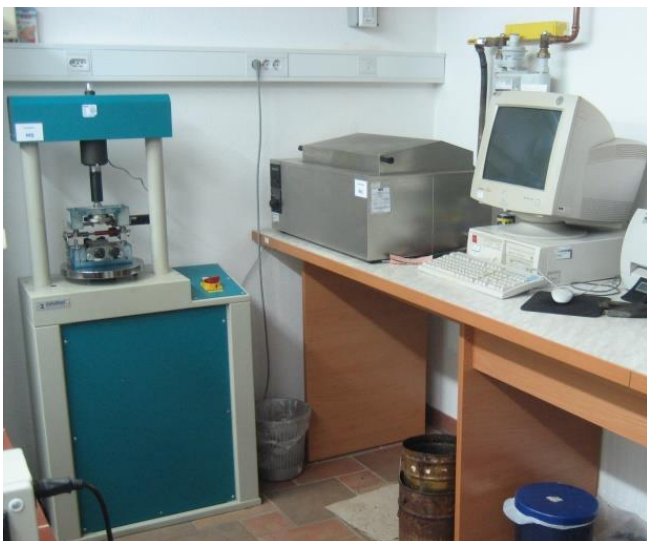
Slika 4-14: Stiskalnica za določanje indirektna natezne trdnosti s pripadajočimi čeljustmi in programsko opremo ter vodna kopel za obdelavo mokrih vzorcev pri 40 °C
