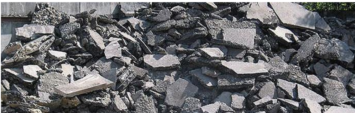
Slika 2-3: Asfalt v kosih, nalomljen z bagri pri odstranjevanju z vozišča [65]
