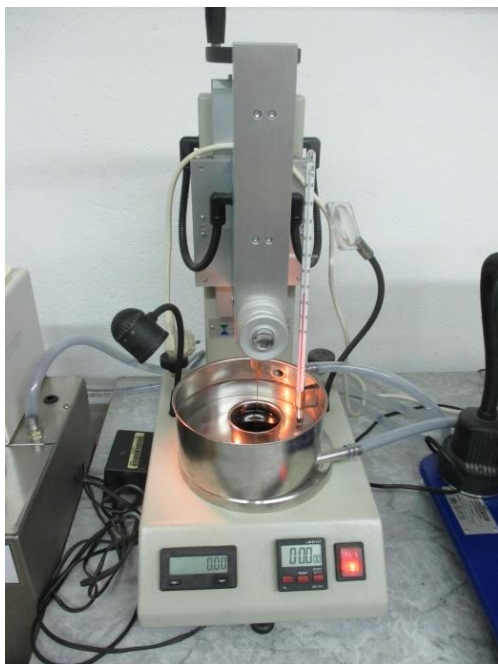
Slika 4-7: Določevanje penetracije z iglo bitumna B50/70
