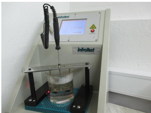
a) b) Slika 4-6: Določanje PK bitumna B50/70: a) med postopkom, b) konec postopka
