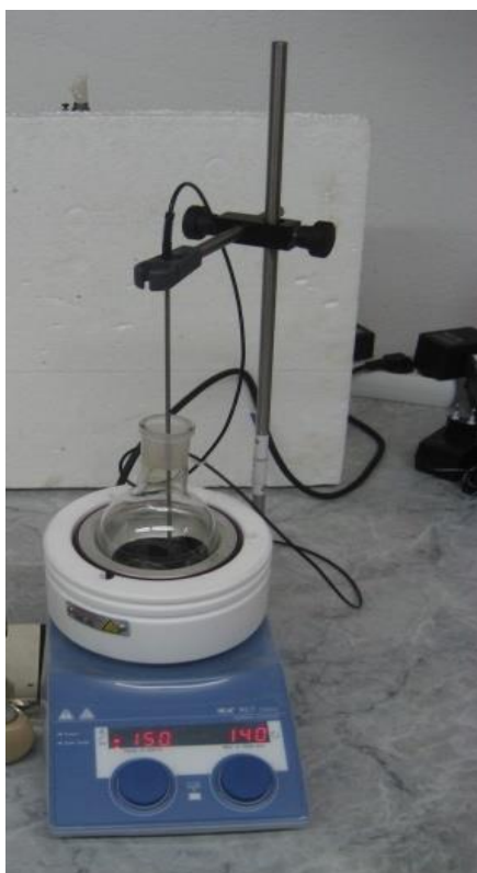
Slika 4-5: Priprava vzorca zmesi bitumna in mešanice kamena moka Očura/livarski pesek za določanje delta prstan-kroglica
