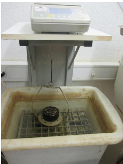
Slika 4-11: Ugotavljanje prostorninske gostote asfaltnega preskušanca – Tehtanje vzorca pod vodo
