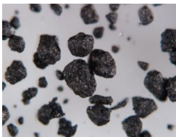
Slika 2-8: Livarski pesek pod mikroskopom.brez bentonita: a) 30x povečava b) 75x povečava – EFI
