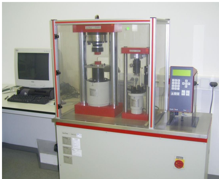
Slika 17 Naprava s katero se preskuša tlačno in upogibno trdnost
