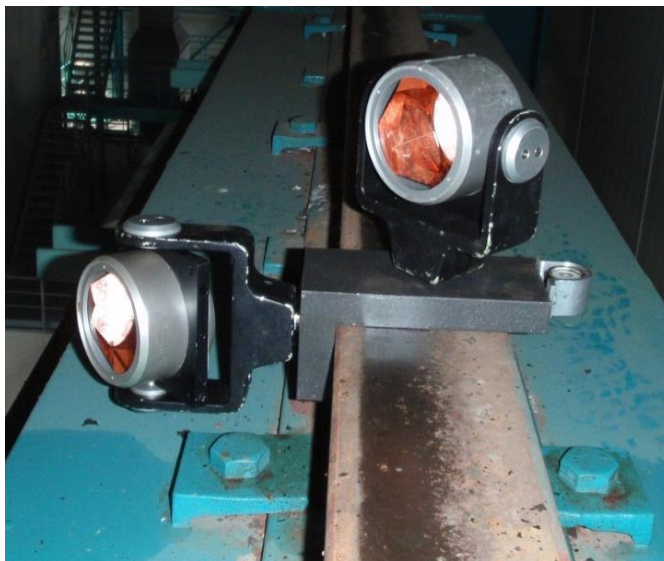
Slika 5: Sistem za meritev položaja žerjavne proge (Savšek, 2015)
