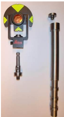
Slika 8: Sistem za stabilizacijo kontrolne točke (Savšek, 2014)
