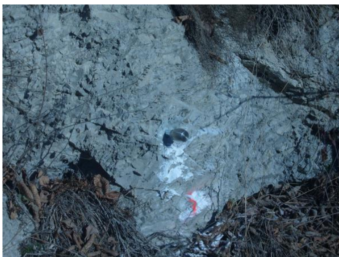
Slika 10 : Primer referenčnega reperja sodčkaste oblike (Savšek, 2010)
