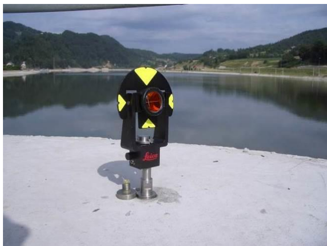
Slika 9: Primer signalizacije kontrolne točke z mini reflektorjem (Savšek, 2014)
