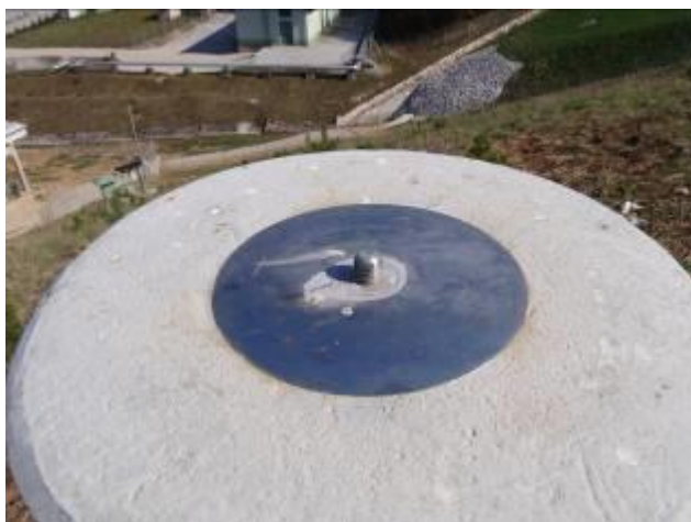
Slika 7: Primer nastavka za prisilno centriranje (Kogoj, 2011)
