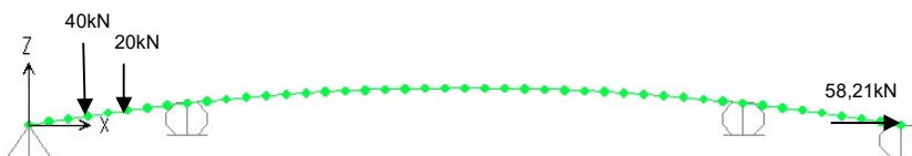
Slika 24: Prikaz razporeditve skupine prometne obtežbe ( Q_{serv,1} in Q_{flk,1} ) gr2
