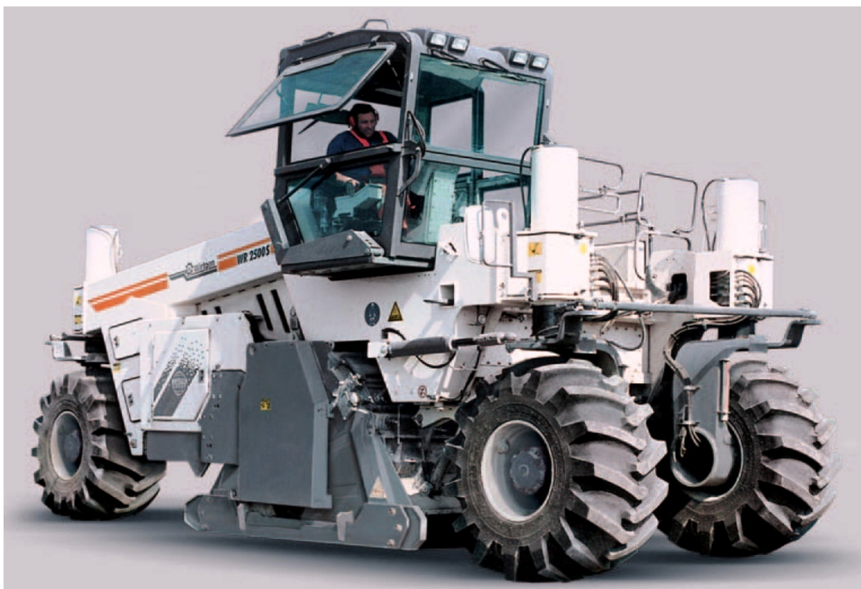
Slika 11: Wirtgen reciklator Wirtgen WR 2500 S
