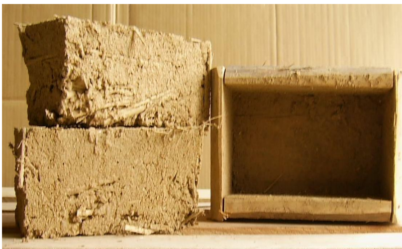
Slika 17: Ilovnati zidaki, pripravljene za sušenje [46]
